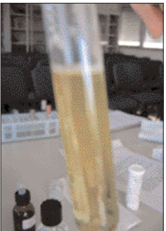
figura 15 Lettura dopo la rinnovata ebollizione dell'urina acidificata: in presenza di proteine o derivati proteici dopo l'acidificazione ricompare un intorbidamento al disotto dello strato in ebollizione.
