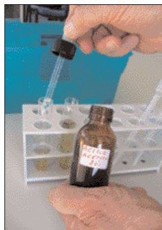
figura 6 Esecuzione della prova di Heller: acidificazione preliminare del campione con poche gocce di acido acetico.
