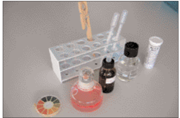
figura 2 Materiale pronto per l'esame: cartine indicatrici (pH e corpi chetonici), acido acetico al 20%, acido nitrico fumante, becco Bunsen ad alcool, pinza portaprovette, due provette, pipette monouso.
