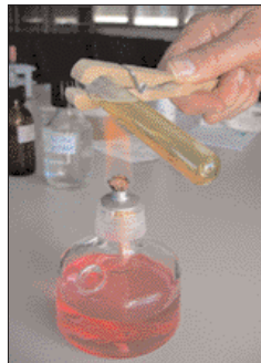
figura 11 Prova a caldo: senza preventiva acidificazione, si porta l'urina contenuta nella provetta n. 2 al disopra della fiammella, riscaldandola lentamente e ripetutamente fino all'ebollizione.
